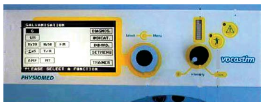
Figura 24.2. Equipo de electroestimulación “Vocastim”. Está diseñado específicamente para el electrodiagnóstico y la reeducación de la musculatura vinculada con el área laríngea en los trastornos del lenguaje.
