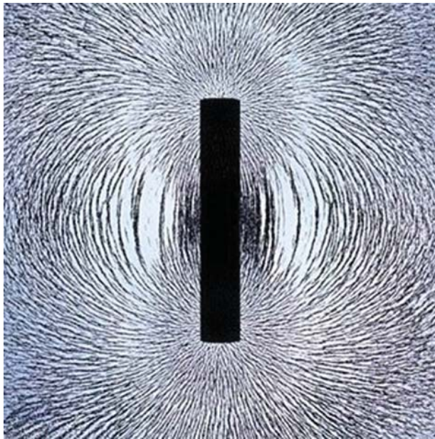
Figura 26.1. Barra imantada, sobre la cual se echó limadura de hierro. La limadura se alinea y pone en evidencia las líneas de fuerza del campo. Se observa que las líneas de fuerza salen de un extremo y se curvan para llegar al otro extremo; estas líneas pueden considerarse como bucles cerrados, con una parte del bucle dentro del imán y otra fuera. En los extremos del imán, donde las líneas de fuerza están más próximas, el campo magnético es más intenso; en los lados del imán, donde las líneas de fuerza están más separadas, el campo magnético es más débil.
