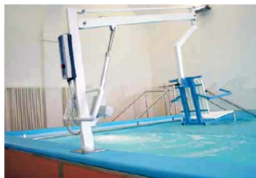
Figura 8.2. Detalle donde se observa el muro y la grúa de acceso de los pacientes a la piscina. En su extremo se encuentra una silla especial que tiene sistemas de fijación.
