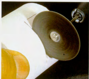
Fig. 6-124j. El refractario enfriado se desbasta cuidadosamente.
