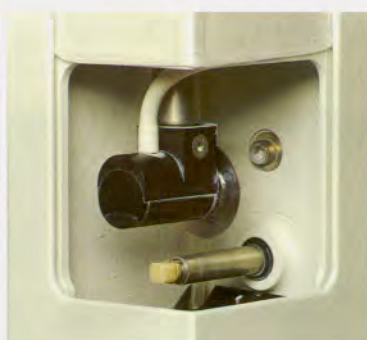
Fig. 6-111. Cámara de tallado con motor eléctrico y disco de diamante de 40 mm.
