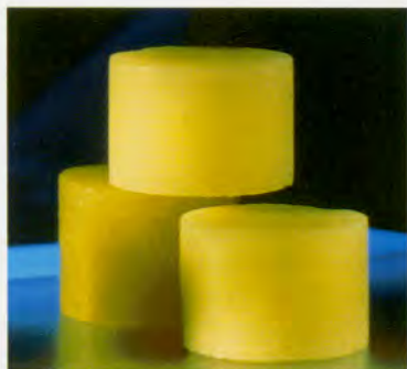
Fig. 6-123. Lingotes de vitrocerámica precristalizada y coloreada IPS Empress®.
