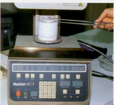
Fig. 6-71gg. Sinterización de la carilla de cerámica.
