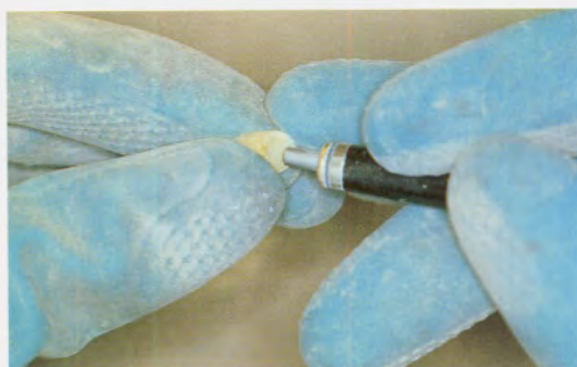
Fig. 6-70z. Con cuidado, cortar y chorrear con arena el material refractario.
