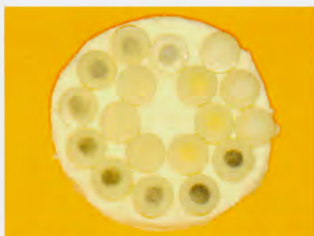
Fig. 6-66b. Tras el ciclo térmico de glaseado se observa un cambio de color en algunos tintes.
