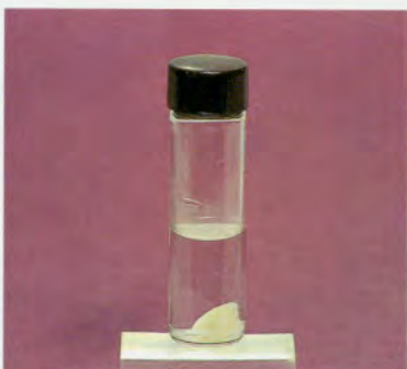
Fig. 6-67t. Se coloca la corona en un bote cerrado de acetona y se sumerge en un limpiador ultrasónico.
