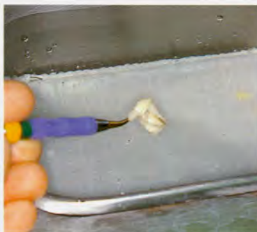
Fig. 6-104b. El agua caliente acelera la polimerización.
