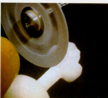
Fig. 6-124k. Se corta el bebedero.
