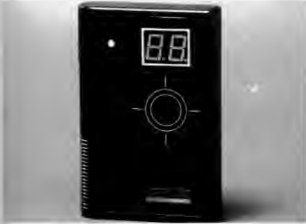
Fig. 3-16. Radiomedidor (Sure Cure Meter, HO Dental), empleado para monitorizar el rendimiento de la luz de polimerización.
