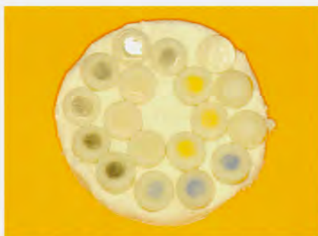
Fig. 6-66a. Tintes de cerámica sobre placas de cerámica antes del ciclo térmico de glaseado.
